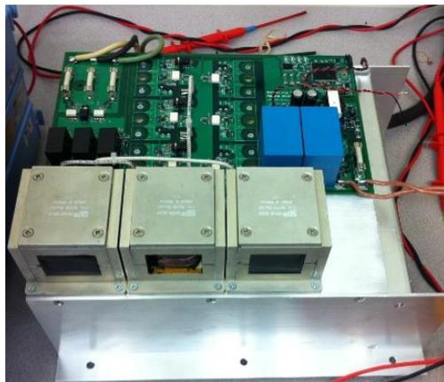
**10kW 98%-efficiency AC/DC PFC**
